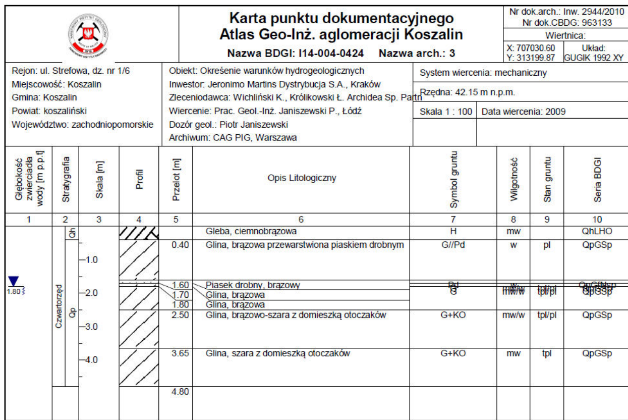
Ilustracja nr 10. Profil geologiczno-inżynierskiego otworu wiertniczego – 114-007-2768.
